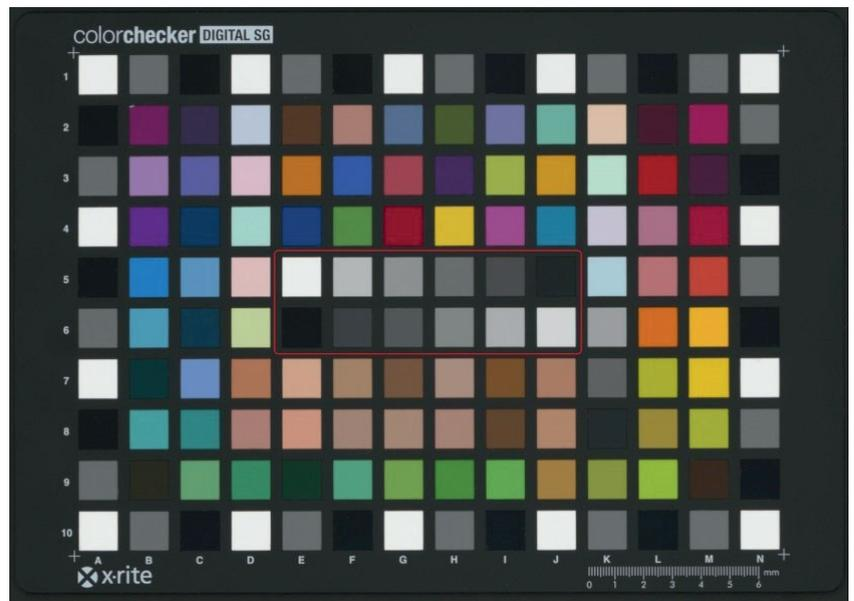
Fig. 3. Patch di grigio per OECF, bilanciamento del bianco e misurazione del rumore
